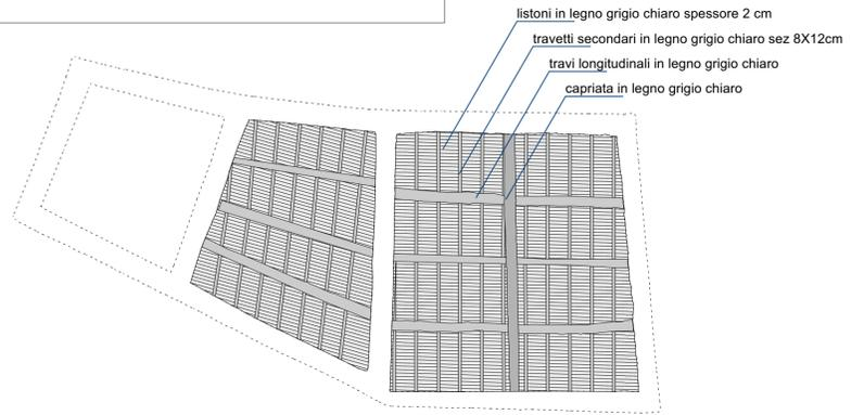
PIANTA DELLE TRAVI A SOFFITTO (VISTA DAL BASSO) - CROMATISMI STATO DI FATTO
